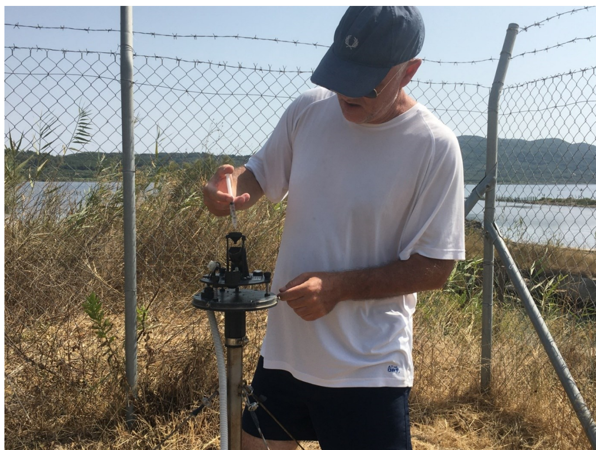
Εικόνα 1.2-6: Απο την βαθμονόμηση βροχόμετρου στον σταθμό CRF-3 (στις 28/7/2021).
