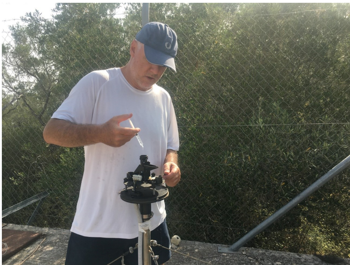
Εικόνα 1.2-10: Απο την βαθμονόμηση βροχόμετρου στον σταθμό ΡΑΧ-1 (στις 30/7/2021).
